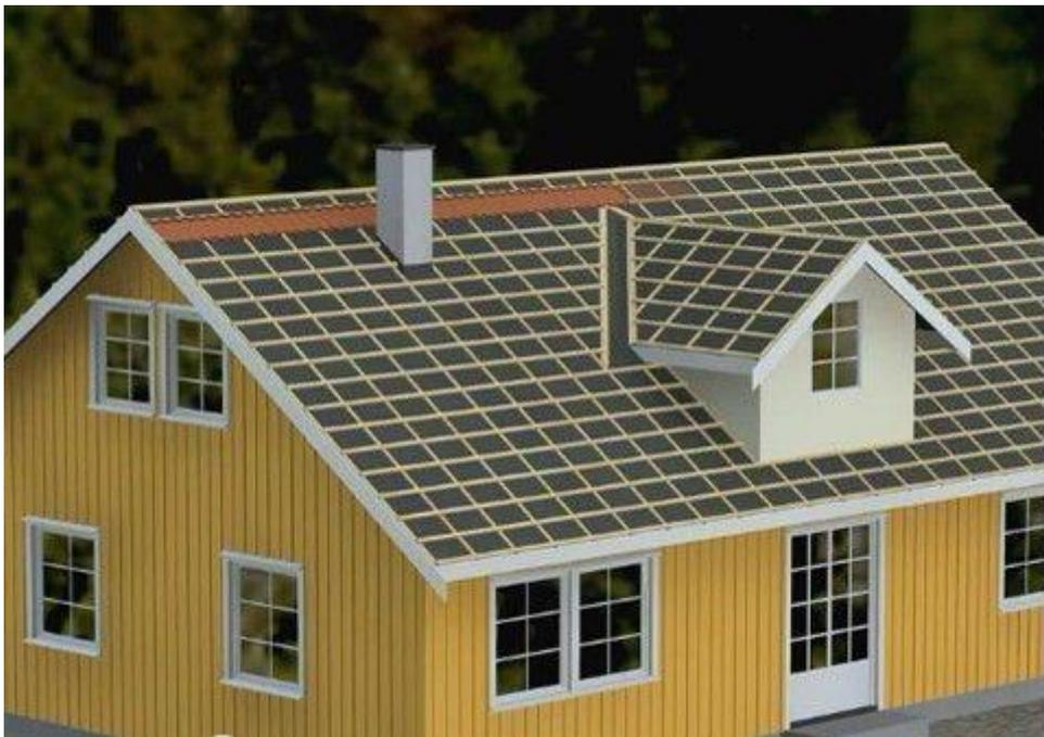
示意图 2：顺水条和挂瓦条布局
