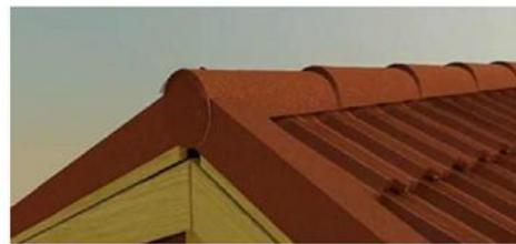
脊瓦安装示意图④
